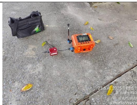
รูป 49 ตรวจวัดแรงสั่นสะเทือนและแรงอัดอากาศจาก การใช้วัตถุระเบิด จำนวน 4 สถานี
