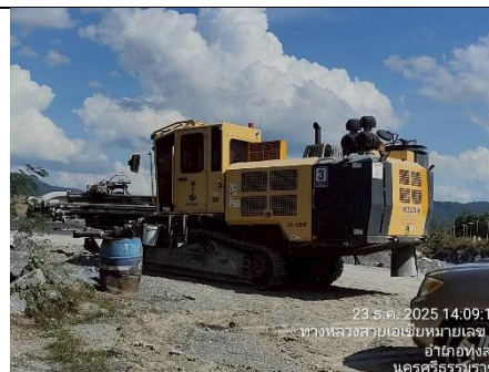
รูป 12 โครงการใช้รถเจาะ Hydraulic Crawler Drill ซึ่งมีเครื่องดูดฝุ่น
